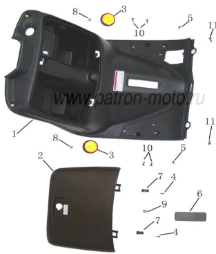
Рис. 10 ОБЛИЦОВКА ВНУТРЕННЯЯ В СБОРЕ
