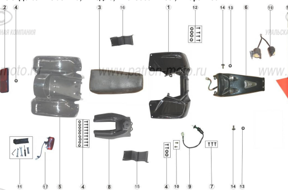
Рис.3 Детали пластика, Седло, Бензобак в сб., Фара в сб.
